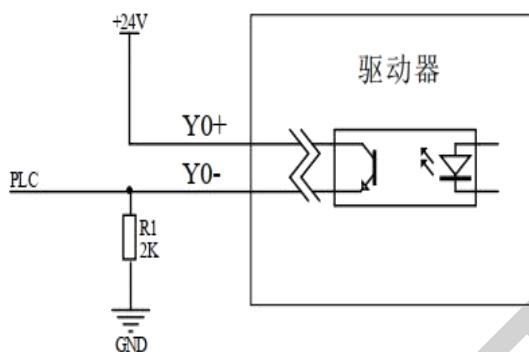
图 3.6 输出接口常闭接法示意图
