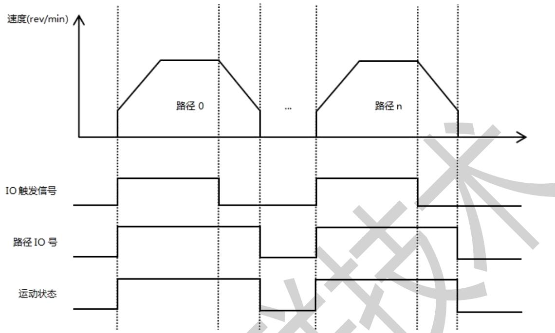
图 5.8 IO 触发+路径 IO 模式运行示意图
