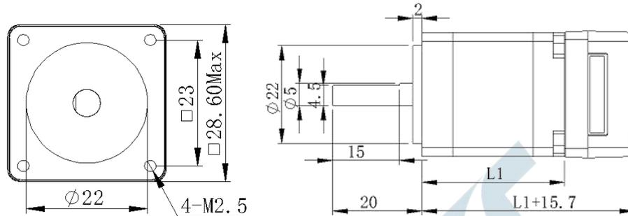
图 6.1 ISS28 系列一体机外观示意图
