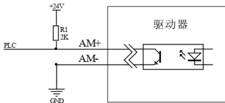
图 3.5 输出接口常开接法示意图
