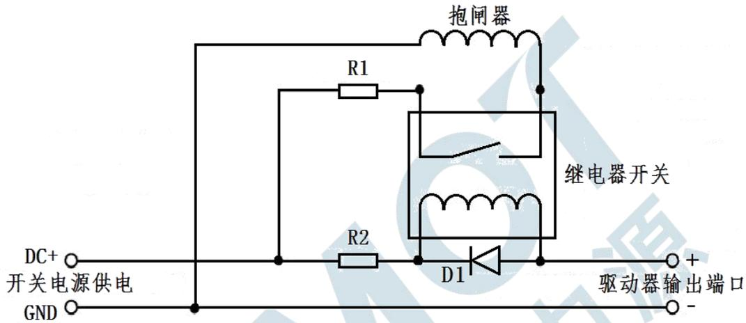
图 3.6 刹车电机抱闸器接线示意图
